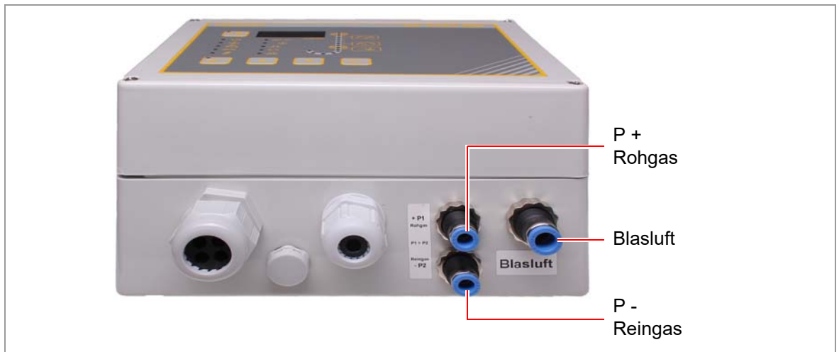
Abb. 7.4: Anschluss für Messschlauchreinigung
