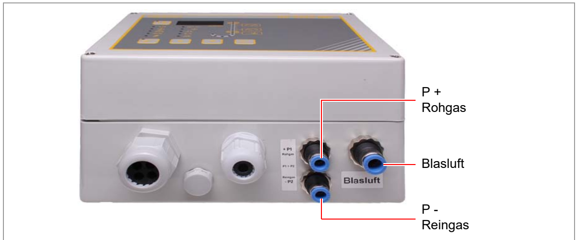
Abb. 7.2: Anschlüsse für Differenzdruckmessung
