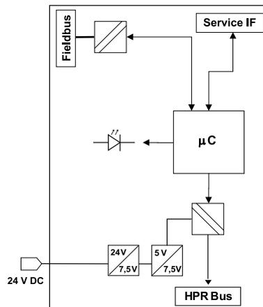
Der Feldbuskoppler HE 5811 verbindet das modulare Prozess-I/O HIMOD-System mit einem CANopen-Netzwerk. Die Verbindung zu dem CAN-Bus wird über einen 9-poligen D-SUB Stecker hergestellt. Es können bis zu 62 I/O-Module je Buskoppler angebunden werden. Die Anbindung der Module erfolgt über ein internes Bussystem. Bis zu 16 Module können direkt am Buskoppler betrieben werden, darüber hinaus kann das System durch ein zusätzliches Powermodul HE 5850 erweitert werden. Im Buskoppler werden
