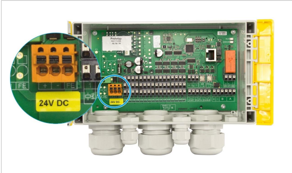
Abbildung 16. HE 5731 Kompakt mit 24 V DC Versorgungsspannung (Anschlussadapter optional)
