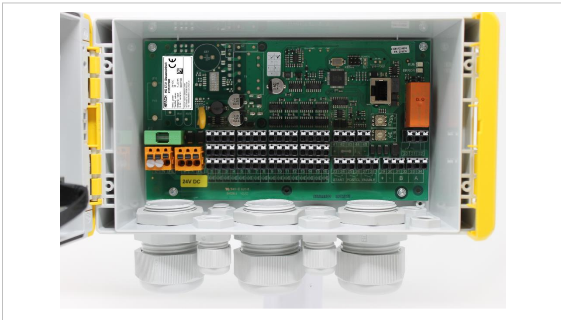
Abbildung 17. HE 5731 Kompakt mit 24 V DC Versorgungsspannung (ohne Anschlussadapter)
