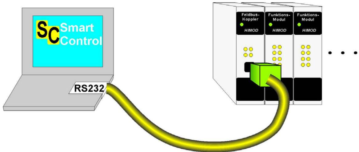
Abb. 12 Anschluss 'SmartControl'
