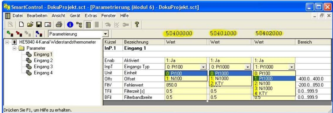
Abb. 8 Bildschirm Parametrierung Modulfunktion Eingangsvarianten
