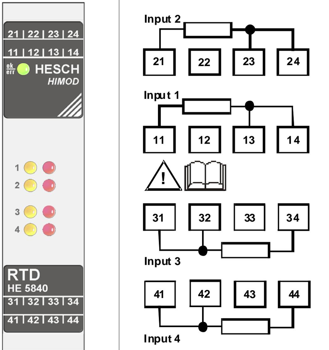
Abb. 7 Frontansicht und Steckerbelegung
