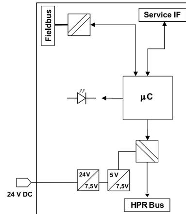
Der Feldbuskoppler HE 5813 verbindet das modulare Prozess-I/O HIMOD-System mit einem Modbus RTU Netzwerk. Die Verbindung zu dem Modbus RTU wird über eine 9-polige D-SUB Buchse hergestellt. Es können bis zu 62 I/O-Module je Buskoppler angebunden werden. Die Anbindung der Module erfolgt über ein internes Bussystem. Bis zu 16 Module können direkt am Buskoppler betrieben werden, darüber hinaus kann das System durch ein zusätzliches Powermodul erweitert werden. Im Buskoppler werden die
