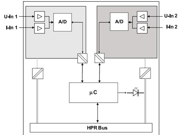
Das analoge Eingangsmodul HE 5832 erfasst bis zu zwei analoge Normsignale (Strom oder Spannung) von der Prozessebene und überträgt diese zum übergeordneten Bussystem. Die Kommunikation mit dem Buskopleer erfolgt über eine asynchrone serielle RS485-Verbindung. Beide Kanäle sind galvanisch voneinander getrennt. Eine zusätzliche Potentialtrennung ist nicht notwendig. Das Modul verfügt über sichere Trennung für Arbeitsspannungen bis 300 V nach EN 61010-1. Im Servicefall kann das Modul
