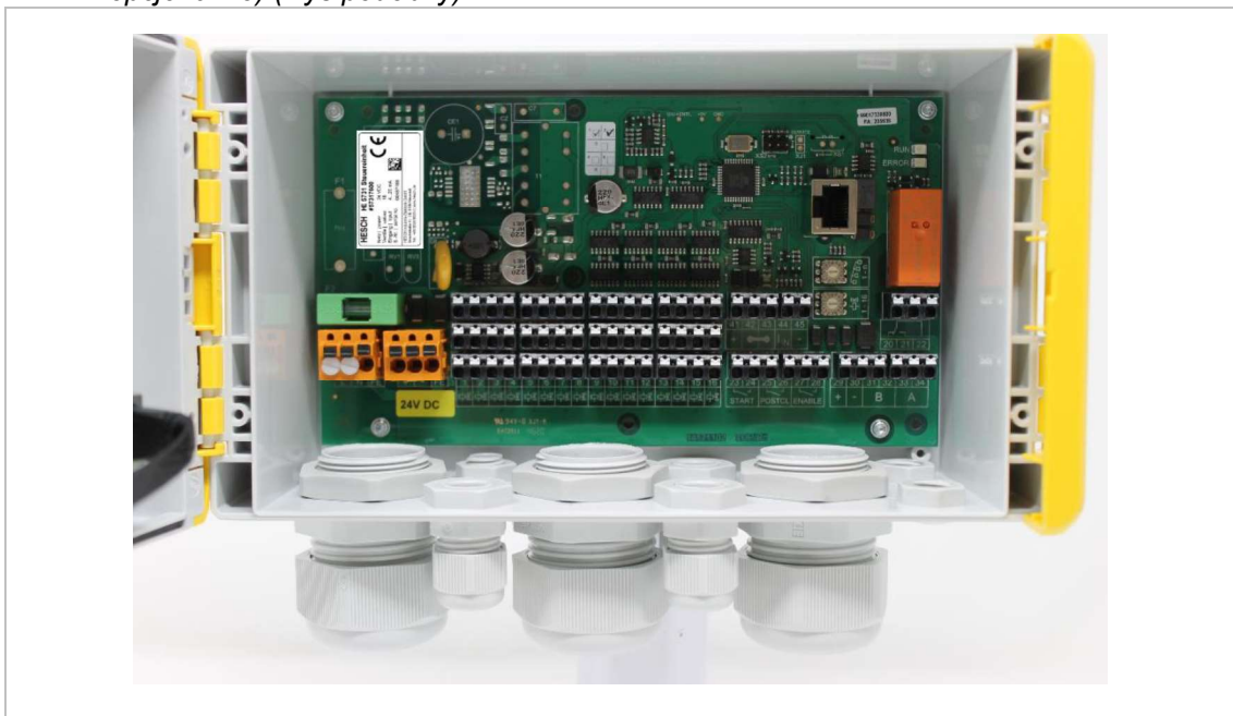
Rysunek 16. HE 5731 Kompakt o napięciu zasilania 24 V DC (bez adaptera przyłącza) (Rys.podobny)
